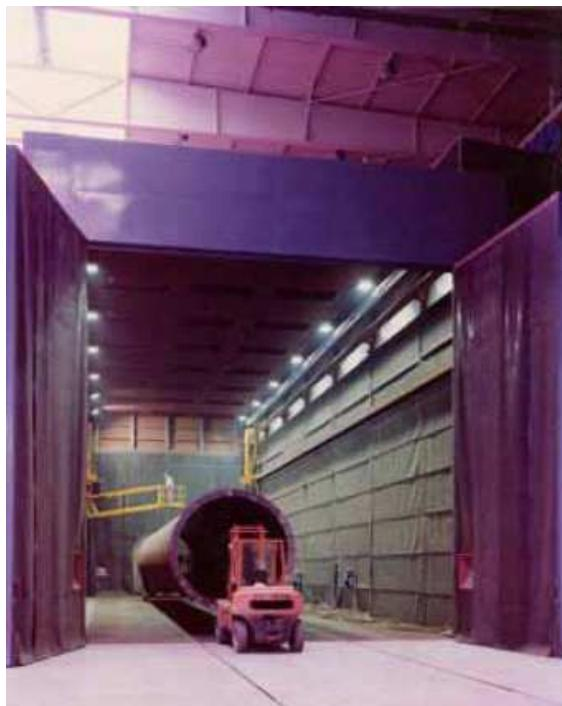
Airblast isporučuje komore za peskarenje u svim zahtevanim dimenzijama. Komore su izradjene modularno od čeličnih panela, lako se mogu izolovati u skladu sa lokalnim standardima koji se odnose na nivo buke. Lak pristup u komoru sa jedne ili sa obe strane, obezbedjen je čvrstim "harmonika" vratima koja vise na specijalnim nosačima sa pouzdanim kotrljajućim ležajima.
