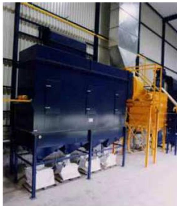
Airblast filteri za prašinu isporučuju se sa kapacitetima od 4.000 do 46.000 m<sup>3</sup>/h. Motori ventilatora se isporučuju sa snagama od 3 do 30 kW. To znači da se za svaku lokaciju može formirati odgovarajući sistem. Kanali za skupljanje prašine mogu se priključiti na malu PVC kesu za sakupljanje isto kao i na "veliku vreću" od 500 litara.
