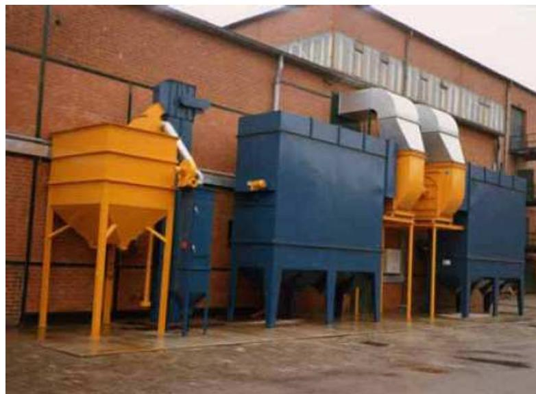
Sistem za izdvajanje, transportuje korišćeni abraziv do uredjaja za prečišćavanje koji se sastoji od elevatorskog sistema, separatora za prenje vazduhom i silosa. Kao opcija moguće je na vrh dodati rotaciono sito i magnetni separator za jednovremeno izdvajanje magnetnog i nemagnetnog abraziva.
